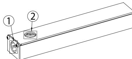
Subsequently, depending on the hole used, make a hole to pass the cable through the end cap or track. Successivamente, a seconda del foro utilizzato, predisporne uno adeguato al passaggio del cavo stesso nel tappo o nel binario.
