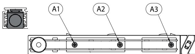
Per il cablaggio delle testate utilizzare cavi 4x1,5mmq. Rimuovere il coperchio della testata svitando le 3 viti A1-A2-A3 in figura per avere accesso ai contatti elettrici.
